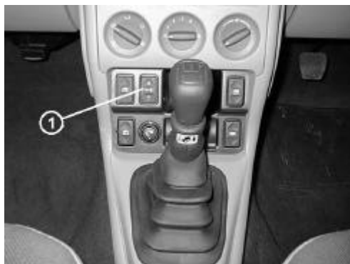
1. Interruptor de cierre centralizado de puertas.
