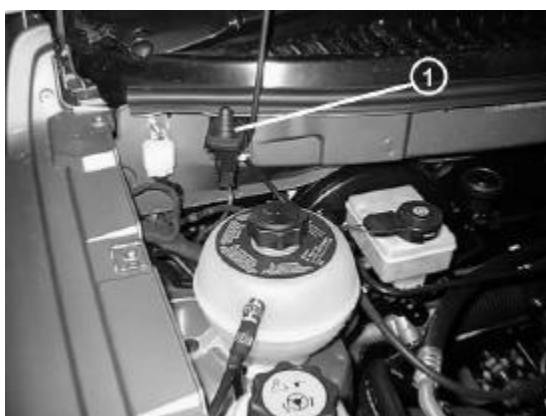
1. Localización del interruptor del capó
