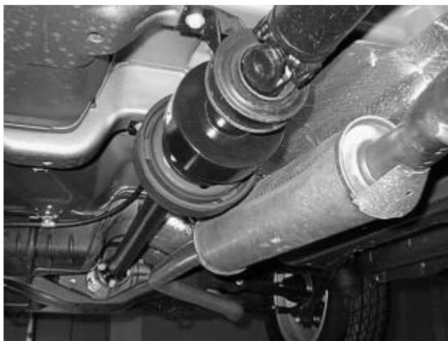
Parte posterior del árbol de transmisión delantero junto con la VCU y los cojinetes.
