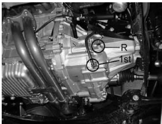
Interruptores de 1ª y marcha atrás.
