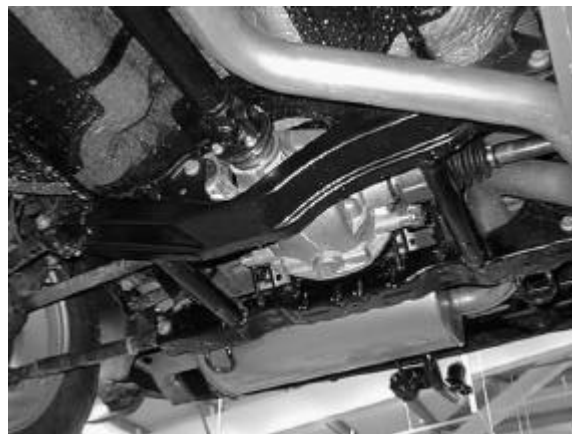
Conjunto de diferencial trasero instalado
